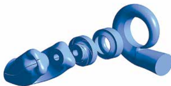
شکل ۱- مدل هندسه ۳ بعدی پمپ گریز از مرکز دو مکشه. (1) Suction chamber (2) Impeller (3) Cavity (4) Volute
